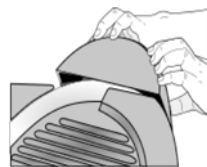
FIG 3. INSTALACIÓN DE AFILADOR
