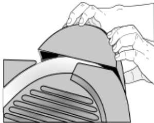
FIG 3. INSTALACIÓN DE AFILADOR
